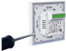
**Шаг 1:** Используйте плоскую отвертку, чтобы отделить рамку и адаптер от терморегулятора, как показано на рисунке
